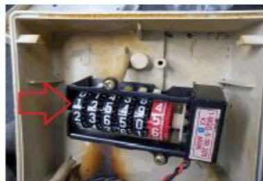
REGISTRADOR FUERA DE POSICIÓN (Inclinado hacia abajo, no permite tomar lectura)
