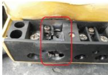
BLOQUE DE TERMINALES QUEMADO (Terminal de salida de la fase)
