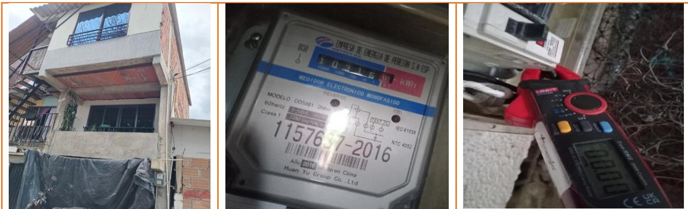
Conforme a lo anterior, se verificó que el medidor se encuentra conforme, registrando el consumo con normalidad, una correcta toma de lectura y se descartan fugas, por lo que se concluye que el consumo es el causado al interior del predio.
