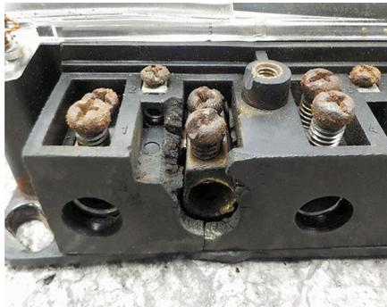
BLOQUE DE TERMINALES QUEMADO (Terminal de salida de fase)
